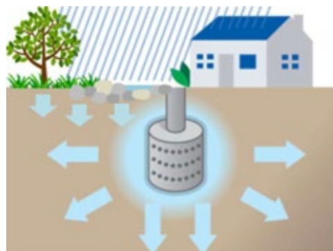
緑化等を伴う雨水浸透施設
