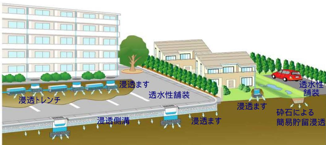
図4-3 雨水浸透施設の設置のイメージ
