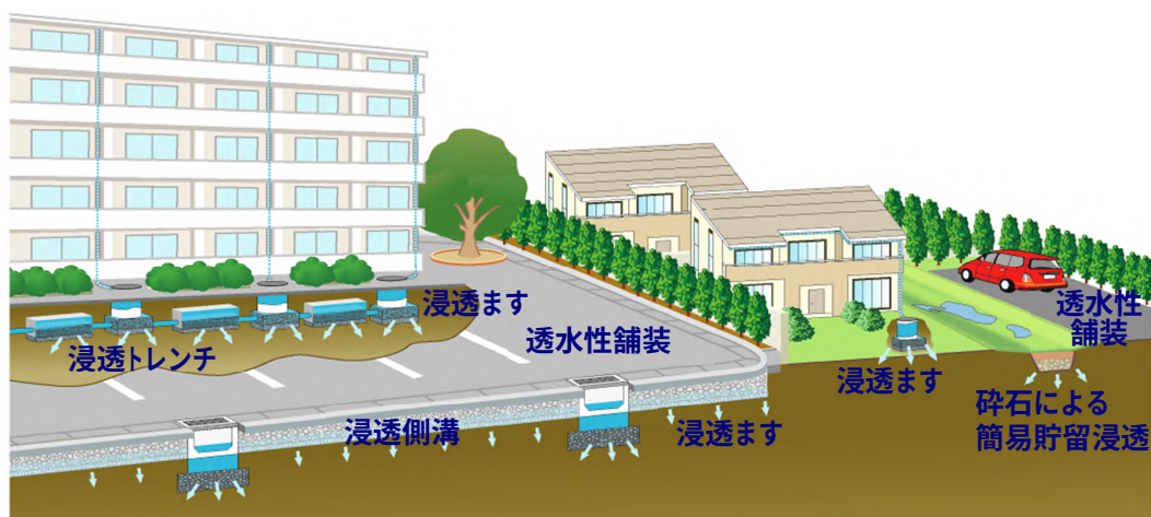
図4-3 雨水浸透施設の設置のイメージ
