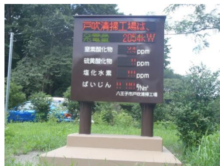
排ガス状況表示盤
